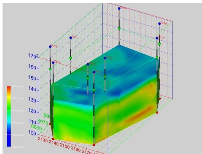
Οριζόντια τομή εδάφους και τρισδιάστατη παρουσίαση κατανομής σεισμικών ταχυτήτων από την περιοχή του Ολυμπιακού Σταδίου. Αποτύπωση αναγλύφου μετά την αφαίρεση του στρώματος χαμηλών ταχυτήτων
