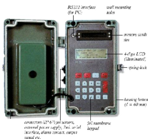
Ηλεκτρονικός Καταγραφικός σταθμός για μετρήσεις στάθμης, θερμοκρασίας αγωγμότητας, διαλελυμένου οξυγόνου, και δυναμικού οξειδοαναγωγής σε γεωτρήσεις.
